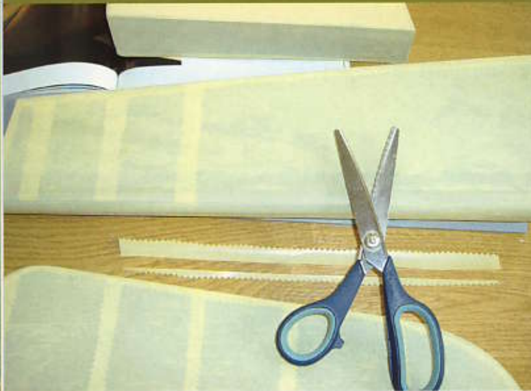
◀ Das Bespannen der Ruder mit Antikfolie und Zackenband; das schneidet man am besten mit einer Zackschere.
