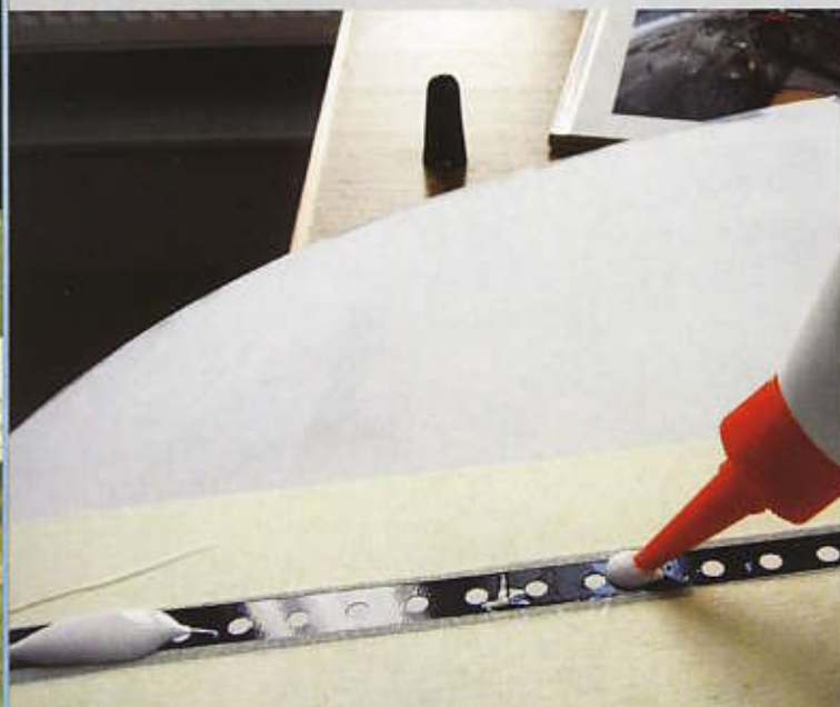
◀ Und so funktioniert die Sache mit den Nieten: Die selbstklebende Lochfolie wird an richtiger Stelle auf die Oberfläche des Modells aufgebracht und anschließend mit Weißleim überzogen.
