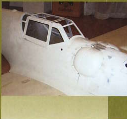
Die Vorfertigung der Bausatz-Komponenten erlaubt ein zügiges Vorankommen bei der Montage des Modells. Die im Text angesprochene »Nieten-Affäre« ist auf der nächsten Seite gezeigt.
