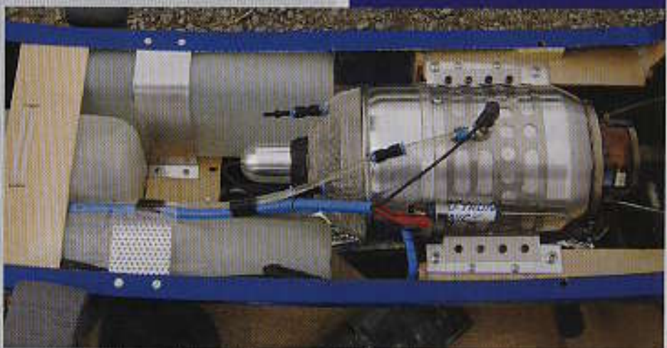
Blick von unten in den Rumpf auf die Turbine mit den beiden Tanks und den Hopper-Tank.
