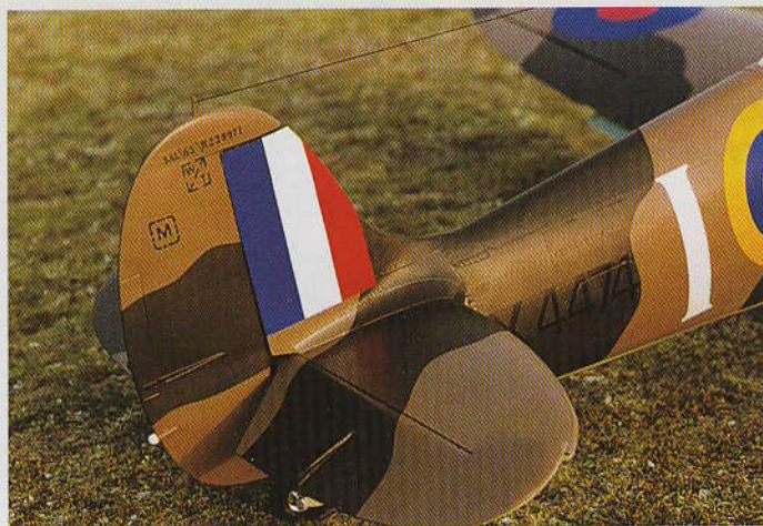
Die Maschine besticht durch ihre detailreiche Oberfläche. Trimmruderansteuerung oder Positionsleuchte am Seitenruder sind leicht zu ergänzen; Beschriftungen für Klappen und Wartungseinheiten wurden aus kopierfähiger Klarsichtfolie hergestellt.
